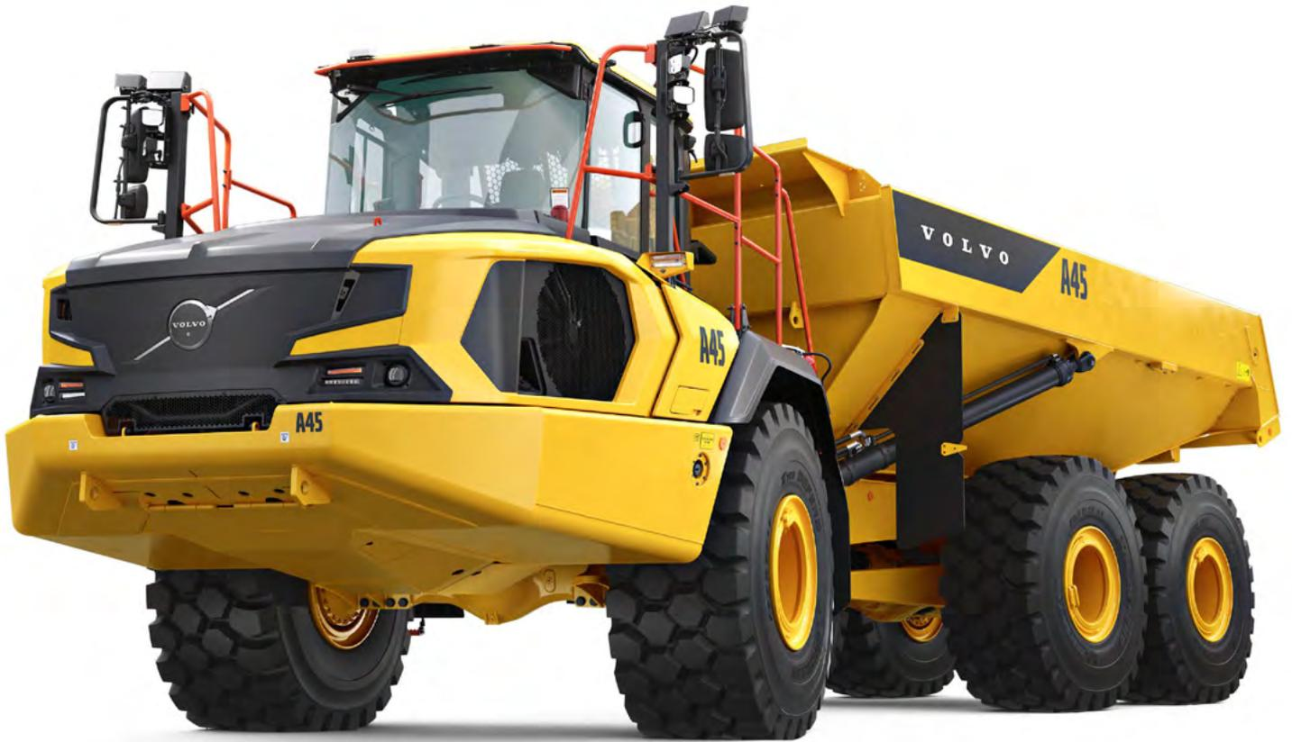
Volvo knickgelenkte Dumper 42,0 t 57 km/h 496 PS
