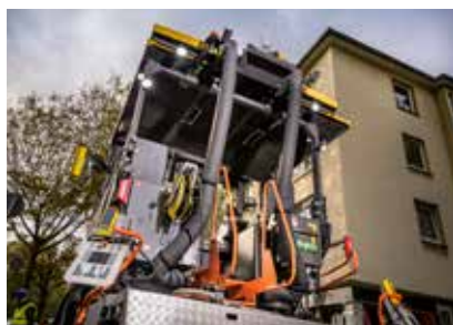
Absauganlage für Bitumendämpfe
