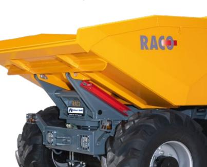
Rutschfeste Alutrittplatten, fahrbereit nur mit aufgeklappten Sicherheitsbügel, mehr Sicherheit durch seitliche Sitzposition und Frontkamera für bessere Übersicht besonders an
